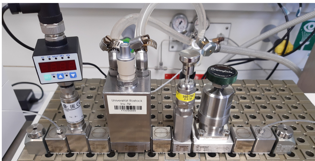
Abb. 4.31.: Mikroreaktor im Strömungsrohr Konzept. Von links nach rechts: Einlass, Drucksensor, Kartuschenreaktor, Überdruckventil, Rückdruckregler und Auslass.
