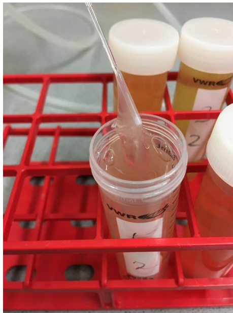
Abb. 23: Geleeartiges Konglomerat im Überstand der 2. Spülung bei 15-minütiger Inkubation eines Imugard® III RC-Filters (Terumo BCT) mit Trypsin.
