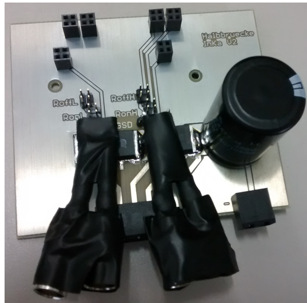
Abbildung 6.9: Testaufbau mit Halbbrücken-Platine (V2) zur Charakterisierung des MOSFET
