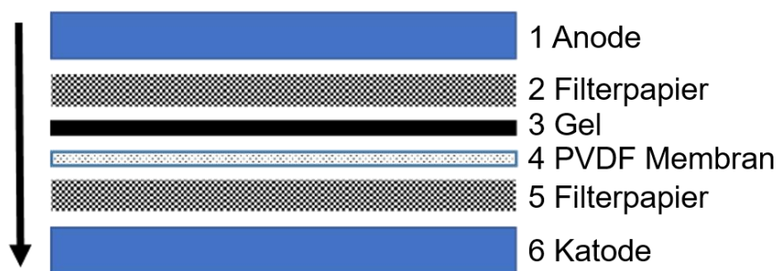
Abbildung 9 Schematischer Aufbau eines Western Blots: Auf die Kathode werden vier in Kathodenpuffer getränkte Blottpapiere gelegt, darauf folgt das Polyacrylamidgel, anschließend die PVDF Membran, die in Anodenlösung II und Isopropanol äquilibriert wird. Vor der Anode werden vier in Anodenpuffer I getränkte und zwei in Anodenpuffer II getränkte Blottingpapiere aufgelegt.
