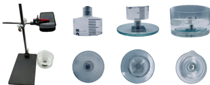
Abbildung 152: gesamter Versuchsaufbau, präparierte Spritze, präparierte Spritze auf Glasplatte, Nahaufnahme Kristallisierschale
