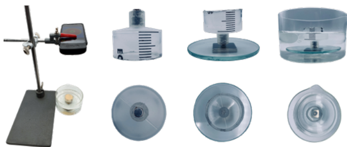
Abbildung 157: Gesamter Versuchsaufbau, präparierte Spritze, präparierte Spritze auf Glasplatte, Nahaufnahme Kristallisierschale
