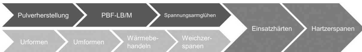
Abbildung 1-3: Additive und konventionelle Fertigungskette im Vergleich
