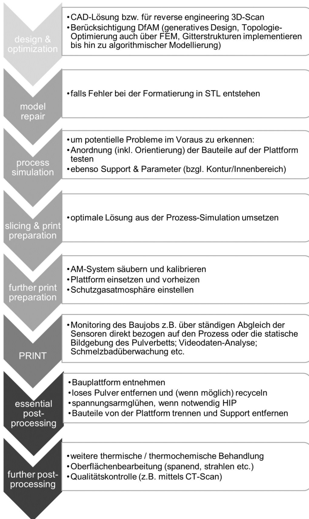
Abbildung 2-12: Umfänglicher Workflow bei der Bauteilherstellung mittels PBF-LB/M in Anlehnung an [6]
