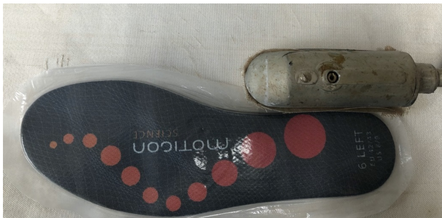
Abb. 15 Einschweißvorgang der Sohlen mit mindestens 1 cm Randsaum
