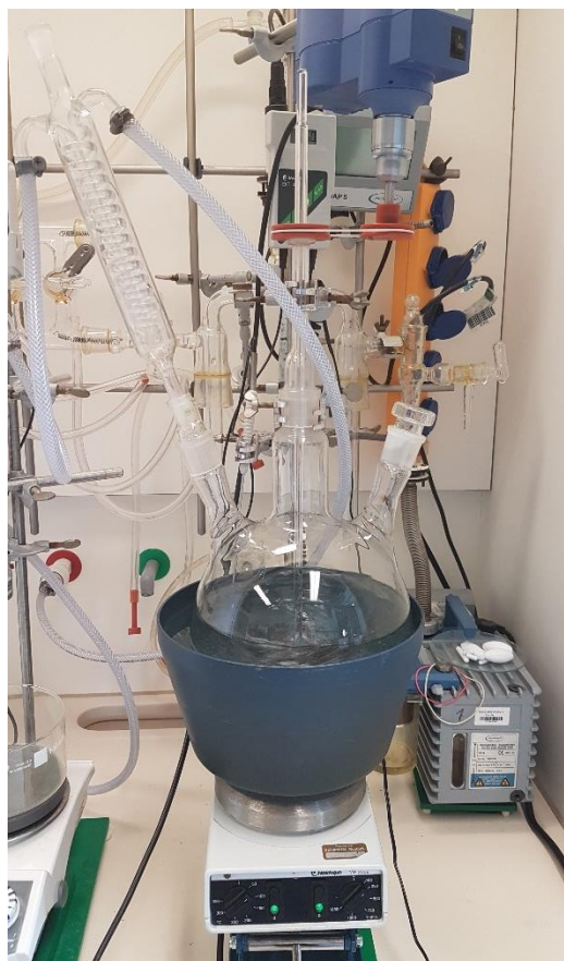
Abbildung 9. Experimenteller Aufbau der diskontinuierlichen Synthese eines Siliconharzes.
