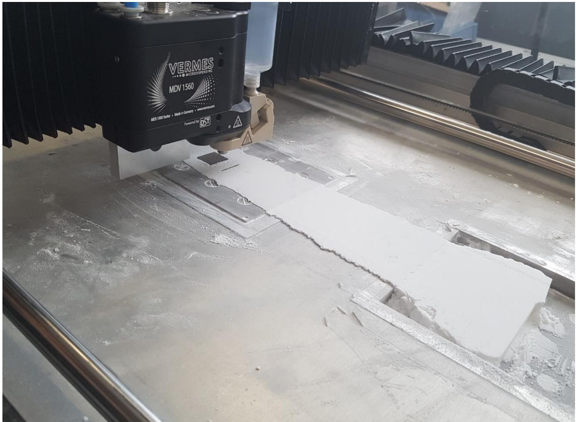
Abbildung 26. Druckversuch mit dem Versuchsaufbau eines BJ-3D-Druckers.
