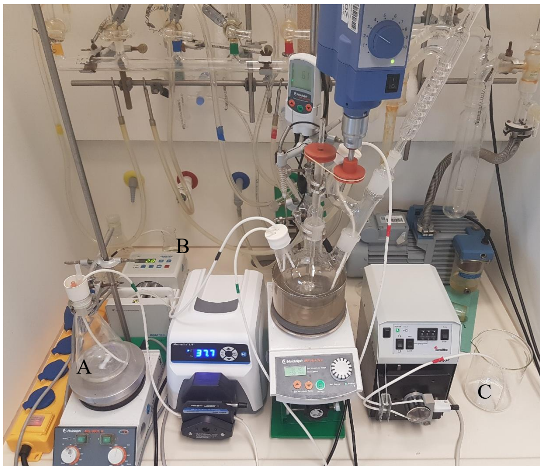
Abbildung 7. Experimenteller Aufbau der kontinuierlichen Synthese von Hydridsiliconharzen: (A) Silan-Ethylacetat-Lösung, (B) entionisiertes Wasser, (C) Reaktionsprodukt.
