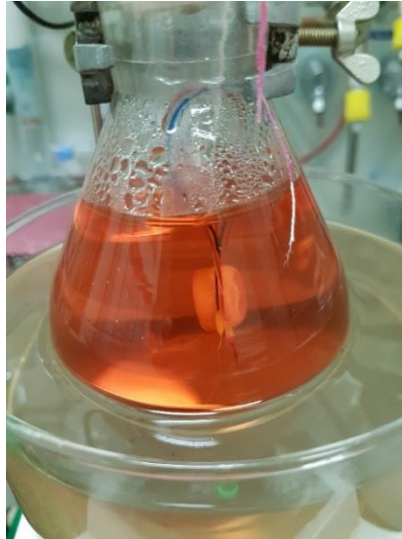
Abbildung 36. Korrosionstest mit dem Zellenkultur-Medium Neurobalsal Plus Medium von gibco mit 30 mmol/L H_2O_2 -Konzentration.
