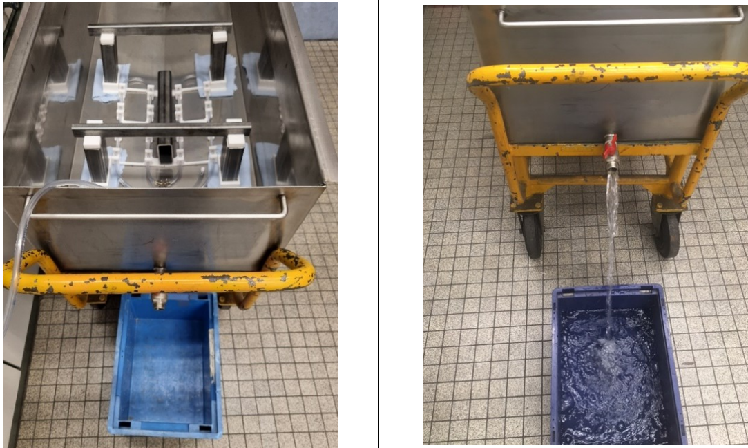
Abbildung 23: Wasserbecken (Kühlung nach Entnahme aus dem Gießwerkzeug).
