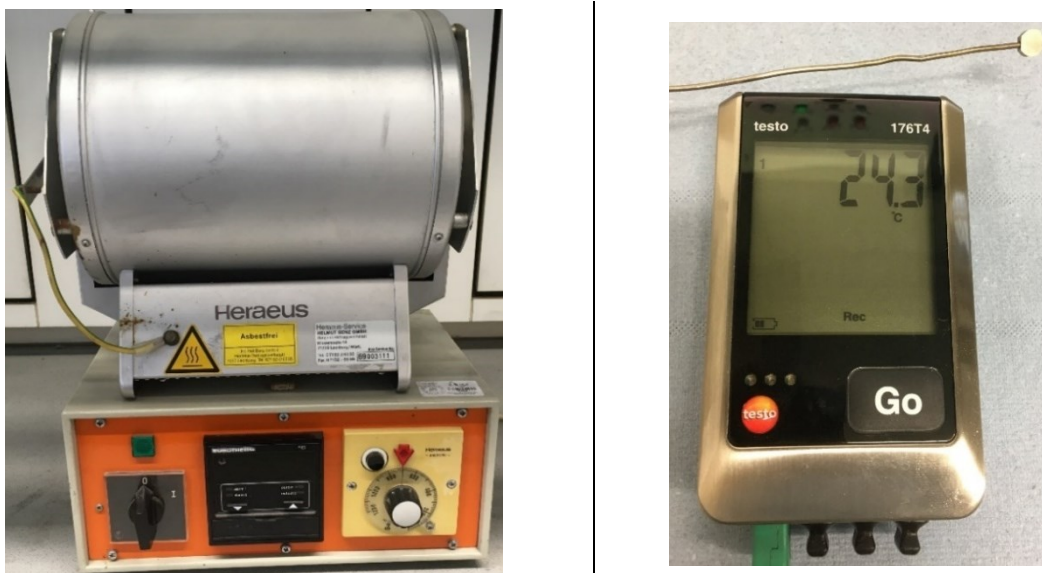
Abbildung 32: Pyrolyseofen (links) und Probekörper mit Thermoelement und Datenlogger des Herstellers „Testo“ (rechts).
