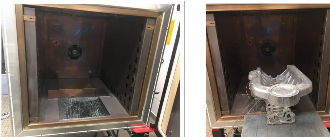
Abbildung 22: Umsetzung der Temperierung des KGHs und Aufbau der Ofenfahrt (Kühlung nach Entnahme aus dem Gießwerkzeug).
