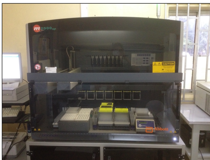
ABBILDUNG 5: AUTOMAT ZUR EXTRAKTION VON RNA (ABBOTT MOLECULAR M2000SP; ABBOTT MOLECULAR INC, USA) IM TUBERCULOSIS REFERENCE LABORATORY BAMENDA (TRLB).
