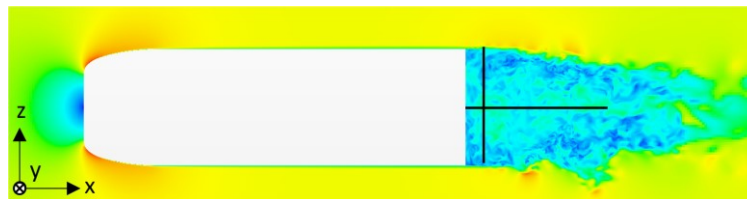
Abbildung 26: Instantane Geschwindigkeitsverteilung in einer xz -Ebene mittig des Grundkörpers ohne Heckeinzug mit Kennzeichnung der für Abbildung 28 und Abbildung 30 genutzten Ebenen.
