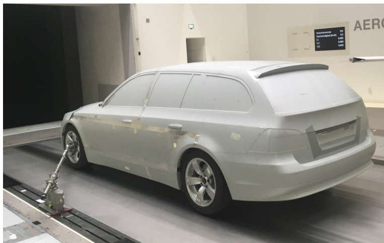
Abbildung 5: BMW 5er Touring (E61) Fahrzeugmodell im Maßstab 1:1 im BMW Modell-Windkanal.
