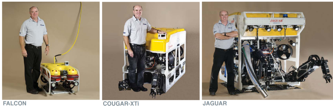
Abbildung 1.2.: Größenvergleich von Links nach Rechts: Observation Class ROV Falcon / Mid-sized Class ROV Cougar-XTi / Work Class ROV Jaguar , alle Fahrzeuge vom Hersteller Saab Seaeye Ltd. [10].
