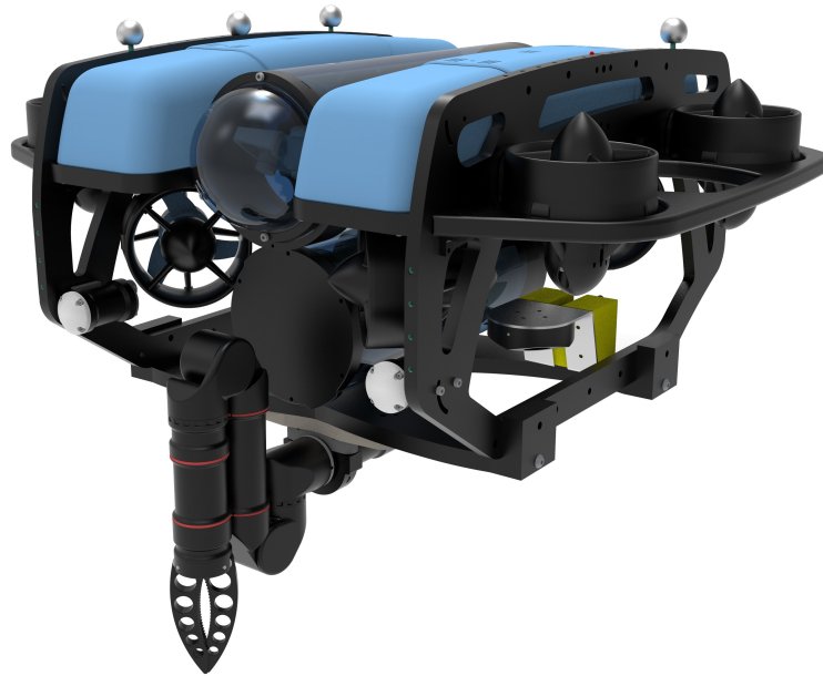
Abbildung 3.2.: Funktionsmodell eines UVMS für die Validierung der Funktion des entwickelten Fahrzeugführungssystems.
