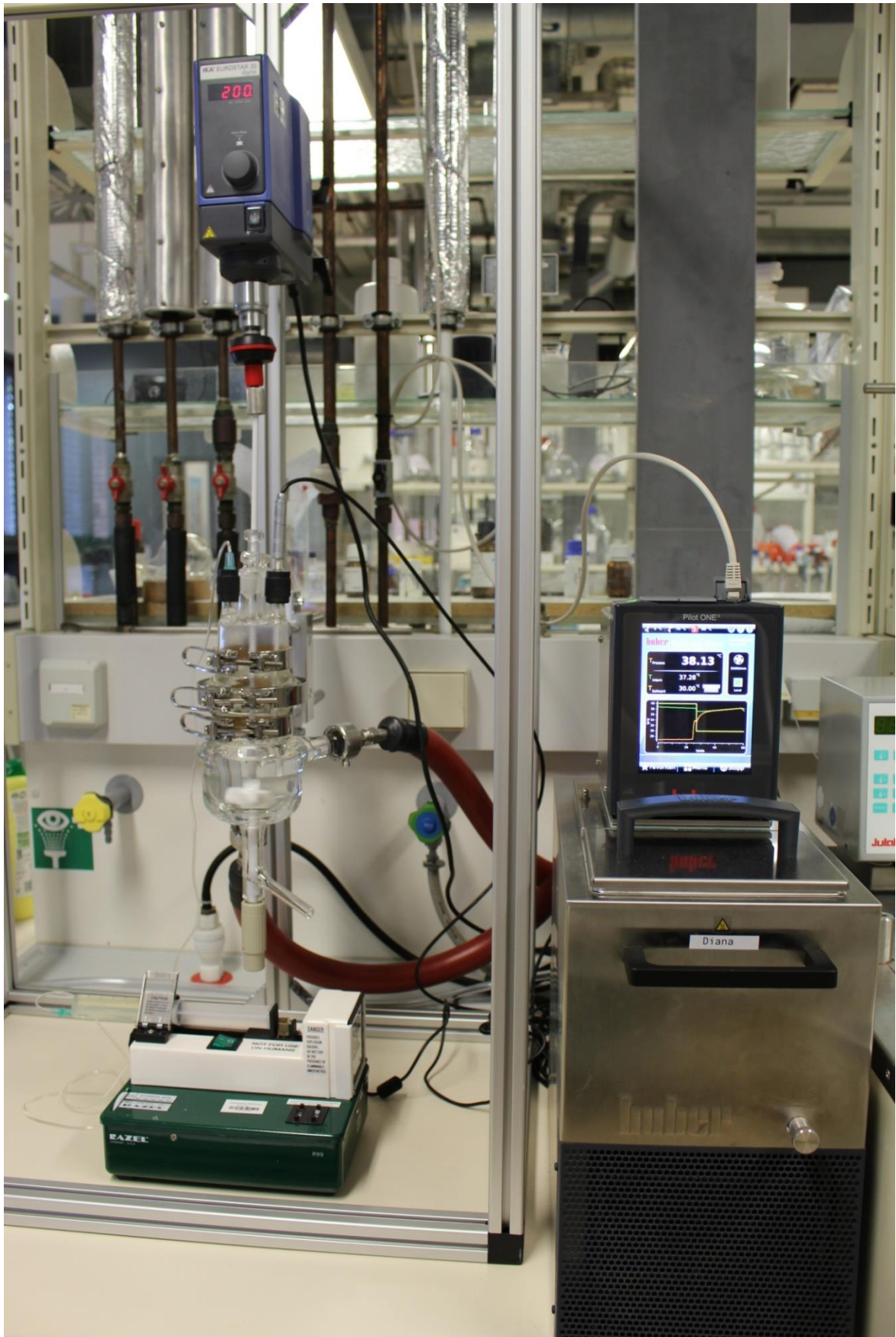
Abbildung 14: Versuchsaufbau für Kristallisationsuntersuchungen: temperierter Reaktor mit Kryostat, Rührer, Temperaturfühler und Kanüle mit angeschlossener Pumpe
