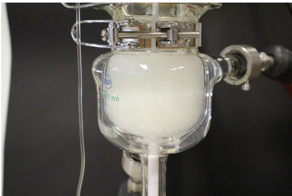
Abbildung 15: oben: einsetzende Kristallisation; unten: vollständige Fällung
