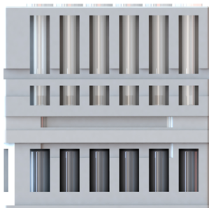
Abbildung 6.9: Stack aus geschlitzten Racks zur Methodenentwicklung
