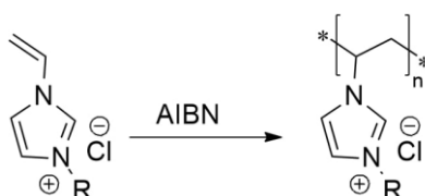
Abbildung 9: Reaktionsschema für die lineare Polymerisation der Vinylimidazol Monomere, durchgeführt in verschiedenen Lösungsmitteln.
