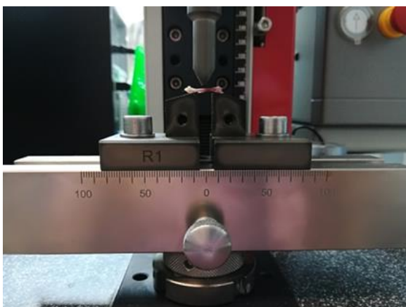
ABBILDUNG 10: POSITION DES FEMURS IM AUFBAU DER PRÜFMASCHINE
