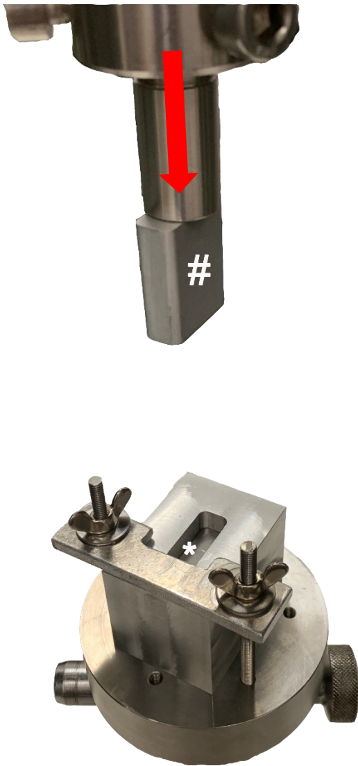
Abbildung 4: Aufgebaute Apparatur. Nach dem Befüllen der Mulde (*) mit Knochengranulat und Klebstoff erfolgte die Pressung der Platten mithilfe des Stempels (#). Die Kraftapplikation erfolgte in Richtung des roten Pfeils.
