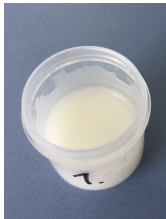
Abbildung 8: Homogenes Gemisch aus Alginat und Atorvastatin nach 5 min im SpeedMixer®
