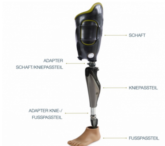
Abb. 1: Exemplarische Darstellung von Aufbau und Passteilen einer modular gebauten Oberschenkelschaftprothese. Die Wahl des Schaftes und der einzelnen Passteile erfolgt individuell. Nach (Lentes Prothesenwerkstatt 2023).
