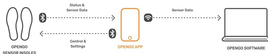
Abb. 2.4 Ablauf des Messdaten-Transfers (Entnommen aus https://moticon.com/opengo/app )
