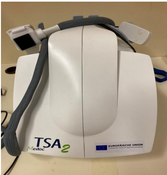
Abbildung 12 Thermal Sensory Analyzer 2 (TSA 2, Medoc, Ramat Yishay, Israel)
