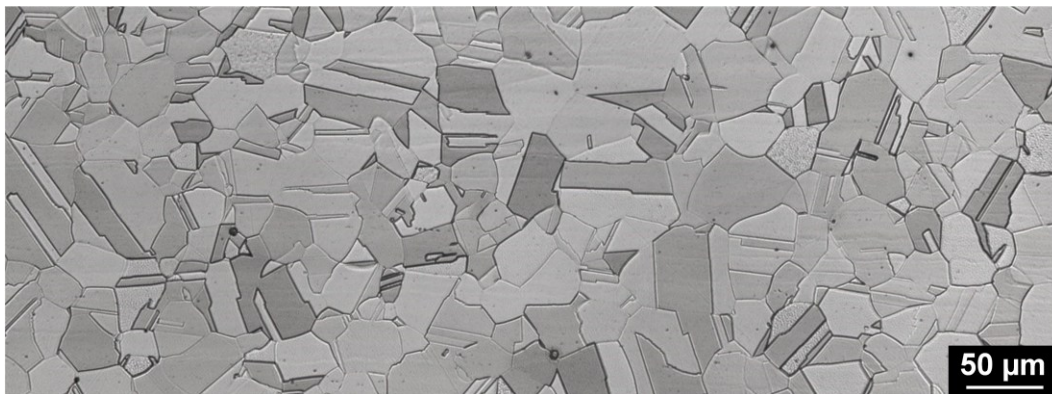
Abbildung 4-2: Austenitisches Gefüge des untersuchten mittelmanganhaltigen Stahls (X2CrMnNi17-7-5)
