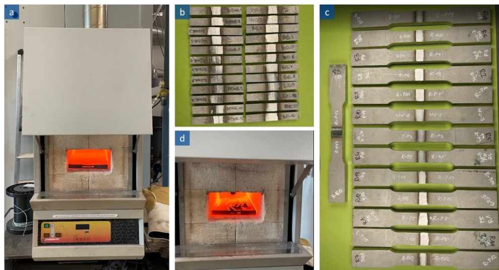
Abbildung 8-1: Verwendeter Laborofen der Marke Carbolite (a), Kerbschlagproben aus bereits verformten Bereichen (b), Zugproben aus bereits verformten Bereichen (c), Proben während der Wärmebehandlung (d)
