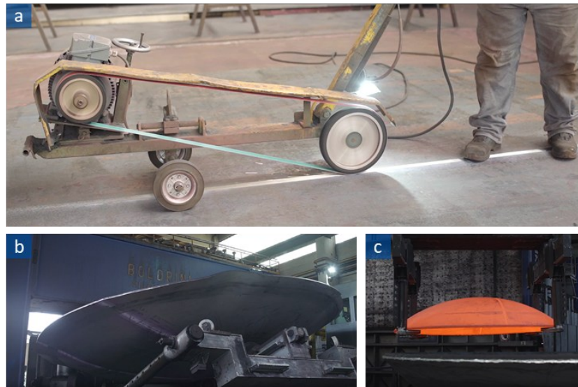
Abbildung 2-9: Beispiel eines Fertigungsprozesses eines Klörperbodens für LNG-Tanks; Planschleifen der Schweißnähte (a), Umformung der Bleche in einer Presse (b), Wärmebehandlung des fertigen Klörperbodens (c) [36]
