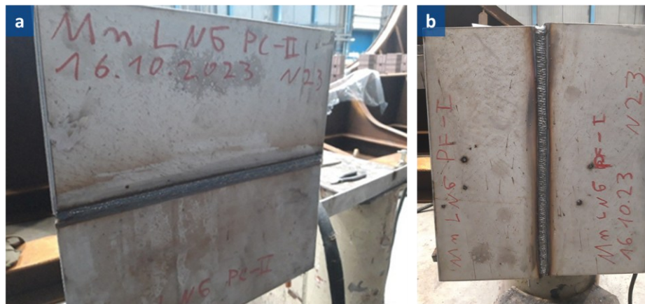
Abbildung 7-3: Geschweißte Demonstratorbleche der Dicke t = 12 mm in Schweißpositionen PC (a) und PF (b)
