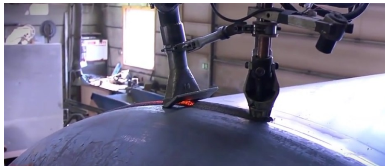
Abbildung 2-8: Schweißen von Rundnähten mittels Unterpulverschweißens in Position PA (Prozess statisch, Bauteil dreht sich) [34]
