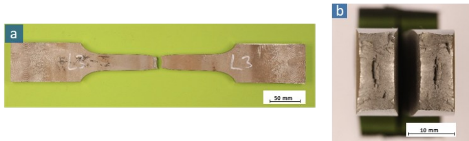
Abbildung 4-4: Geprüfte Zugprobe t = 12 mm: Übersichtsaufnahme (a), Nahaufnahme der Bruchfläche
