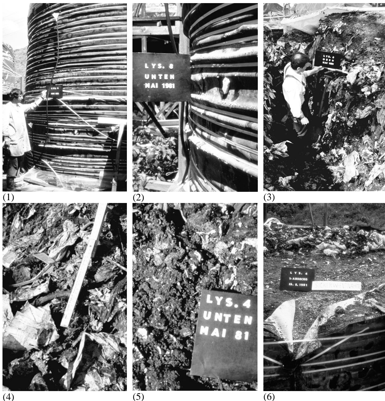
Abb. 9: Ausbau ausgewählter Lysimeter 1, 4, 8. (1) Kontrolle der Außenwand L. 4, (2) Wellung der Außenhaut wegen Sackung L. 8, (3) Schnitt durch Ablagerung L. 8, (4) schlammfreier Hausmüll nach 5 Jahren, anaerob L. 1, (5) Müll-Klärschlammgemisch nach 5 Jahren, anaerob, L. 4, (6) Nachweis der Funktionstüchtigkeit der Sickerwasserentnahme, L. 4.
