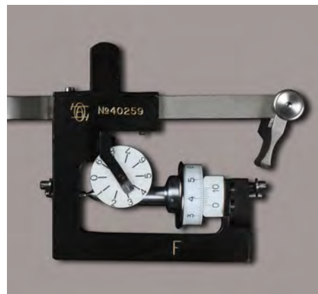
Detailbild mit Fahrarm, Fahrstift und Flächenmesswerk (F) (Foto: ITMZ).
