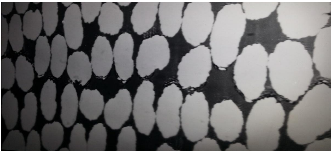
Bild 1: Querschnitt eines Faser-Kunststoff-Verbundes [Scharf]
