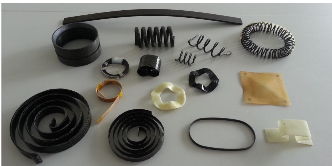
Bild 6: Ausgewählte FKV-Federn [Scharr]
