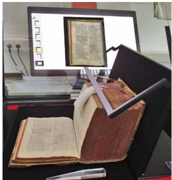
Digitalisierung einer umfangreichen Handschrift mit dem Buchscanner Zeutschel OS 14000 A1
