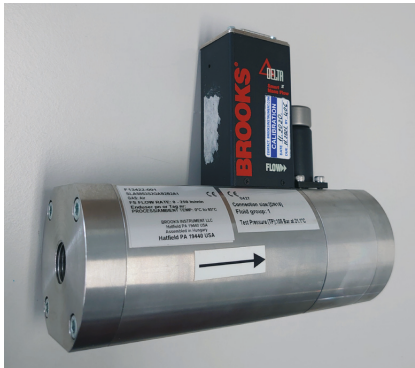
a) Neukalibrierter massiver MFC aus Bestandsanlage, die 105 bar maximale Druckbelastung werden nicht benötigt.
