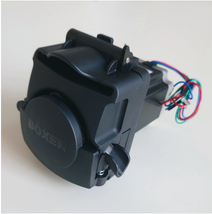
c) Eine von zwei Schlauchpumpen der Fa. Boxer. Der Schrittmotor ermöglicht eine feine Einstellung des Volumenstroms, der zugehörige Schlauch weist einen Innendurchmesser von 8 mm auf, um in Zukunft auch die Flüssigfraktion eines echten Gärrests behandeln zu können.
