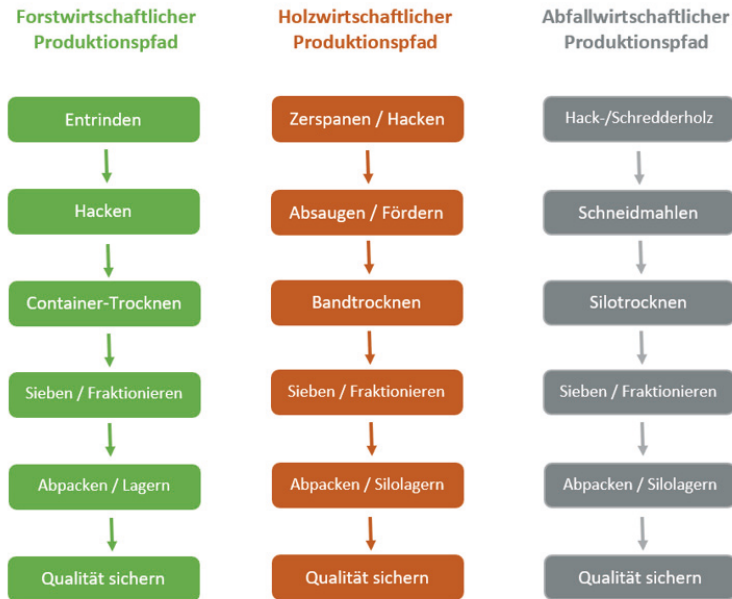
Abb.4: Schema der Produktionspfade zur Herstellung von Präzisionshackgut (PHG)
