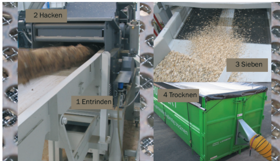
Abb:3: Entinden, Hacken, Sieben und Trocknen zur Herstellung von Präzisionshackgut (PHG) Foto: IBT-Krämer
