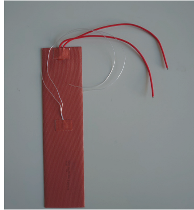
d) Silikonheizmatte mit 300 W elektrischer Leistungsaufnahme und PT100 Temperaturfühler für die Ammoniakstrippkolonne. Die acht Silikonheizmatten für den Kolonnensumpf haben jeweils eine Leistung von 750 W und sind ca. doppelt so groß.
