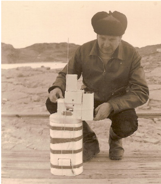
Bild 74 Wolfgang Probst bereitet eine Ozonsonde für den Start vor
