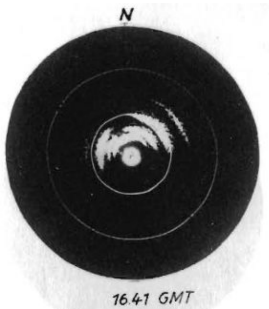
Bild 32 Bildschirm-Bild eines Polarlichts des 33-MHz-Senders, Ringabstand: 500 km (4.9.1958, 16:41 UT)
