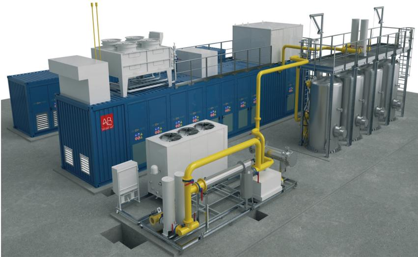
*Abb. 1: Beispielhaft - 3D Zeichnung Biogasaufbereitungsanlage*
