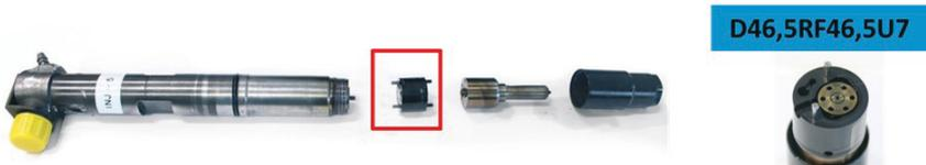
Abb. 2: Demontierte Injektor und die im roten Kasten markierte blockierte Stelle ist vergrößert
