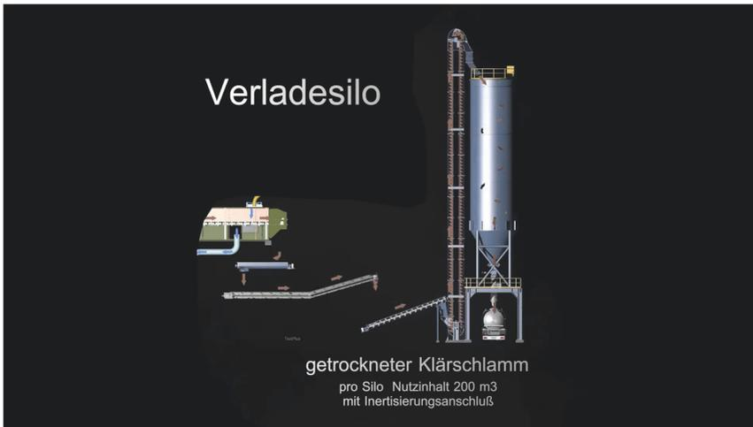
Abb. 9: Darstellung Verladesilo (Nutzvolumen beträgt  $2 \times 200 \text{ m}^3$ )
