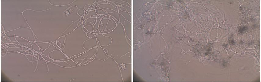
Abb. 2: Lichtmikroskopische Aufnahme der Bakteriensuspensionen bei einer 400-fachen Vergrößerung; links: *Thiothrix nivea* im Kulturkolben unter sterilen Bedingungen; rechts: *Thiothrix nivea*, Trägerschale nach 30 Tagen Aufenthalt in der submersen Stufe der Entschwefelungsanlage
