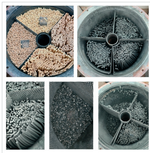
Abb. 3: Befüllte Retorte mit Buchen- und Kiefern- Stangen und Quadern sowie daraus hergestellter Kohlen
