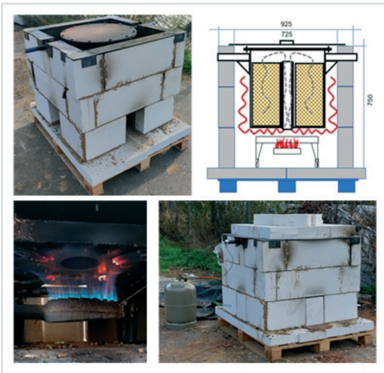
Abb. 1: Konstruktion, Bau und Betrieb des Ofens mit eingehängter Retorte, Gaskocher und Temperaturlogger
