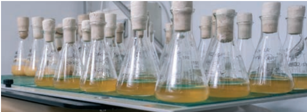
Abb. 4: Submerskulturen (Flüssigkulturen) in Schüttelkolben auf einem Tischschüttler; Foto: Rolf Wegst
