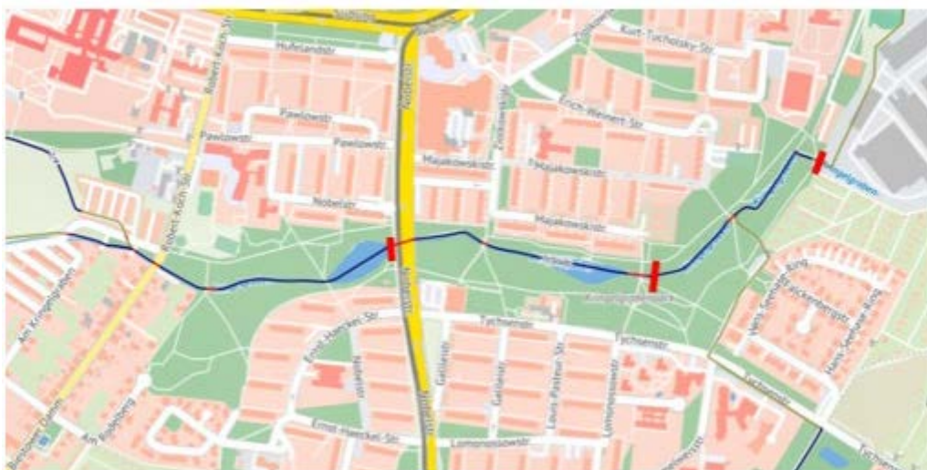
Abb. 4: Kringelgrabenpark mit drei steuerbaren Wehranlagen für den Wasserrückhalt
