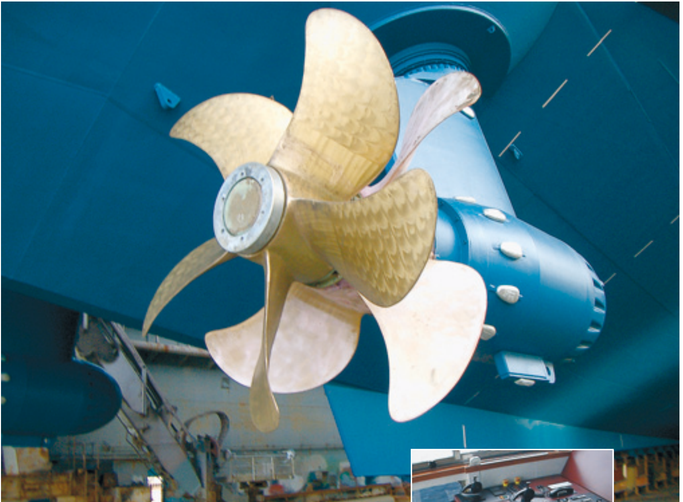
oben: Gegenläufiger Druckpropeller-Azipod der Scandlines-Fähre „Schleswig-Holstein“ (Abb. 1) Foto: Archiv Scandlines Deutschland GmbH
