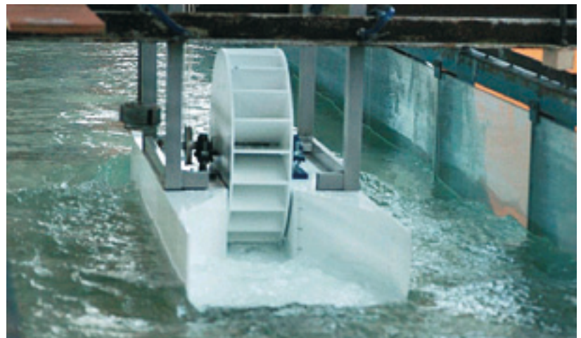
Kleinmaßstäbliches Versuchsmodell (B ~ 0,45 m; L ~ 1,40 m) (Abb. 1)
