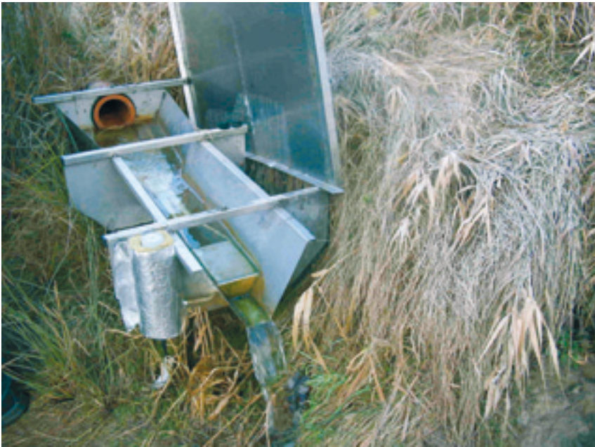
Durchflussmessung am Dränsammler (Abb. 3) Foto: Kahle
