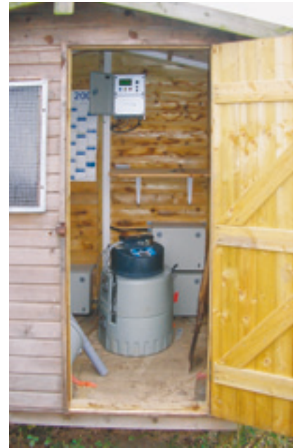
Automatische Probennahme und Datensicherung (Abb. 4) Foto: Lennartz
