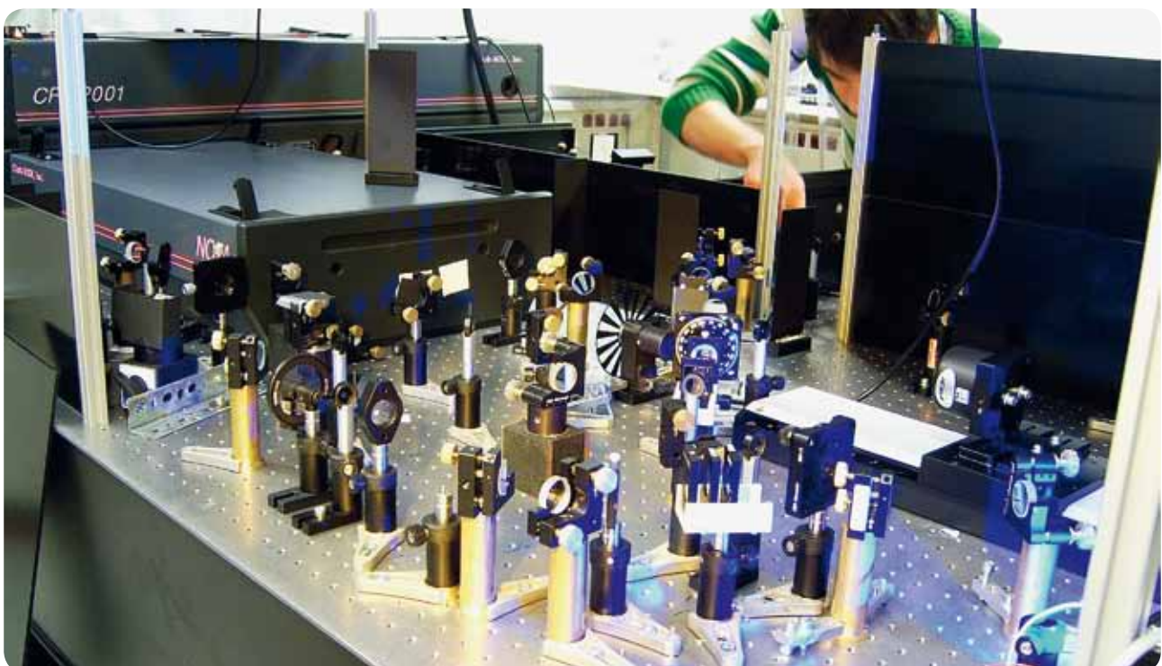
Abbildung 1: Aufbau für die Laserspektroskopie mit höchster Zeitauflösung (30 Femtosekunden)
