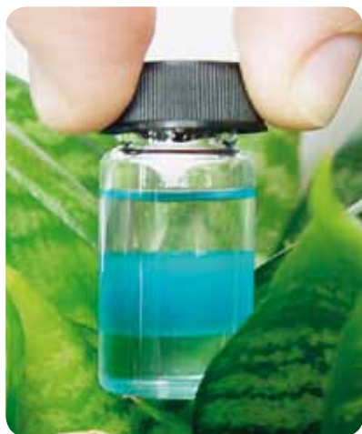
Abbildung 1: 3-Phasen-System mit ionischer Flüssigkeit
