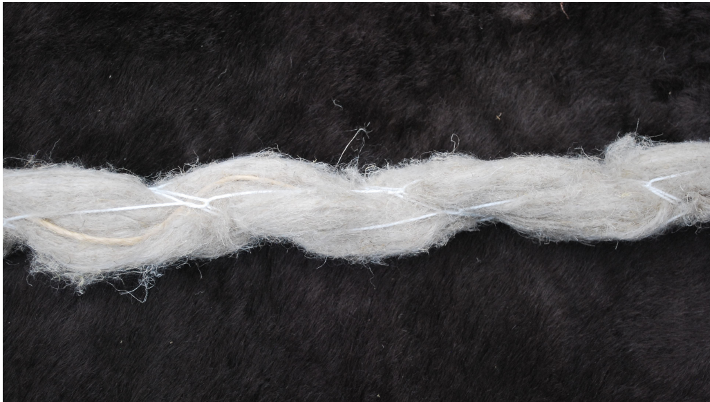
Abb. 2: Aus Hanf gefertigter Strang. Der weitgehend parallele Verlauf der Hanffasern ist deutlich sichtbar. Ebenso sind ein Leitfaden links im Bild sowie der Maschenmantel zu erkennen.
