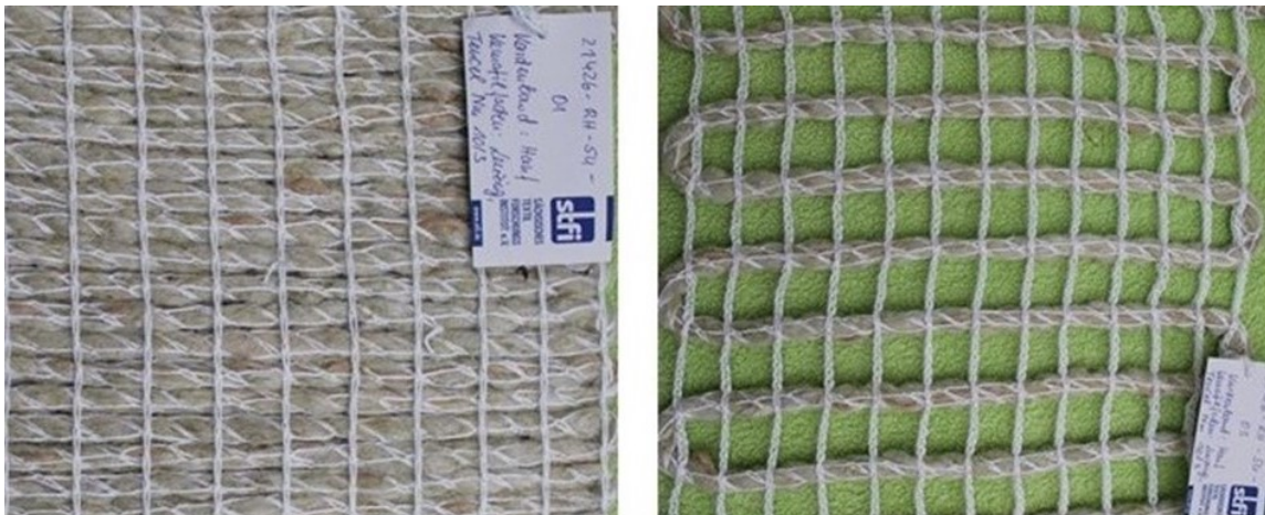
Abb. 5: Vergleich zwischen zwei gitterartigen Strukturen, die zwar aus den gleichen Ausgangsmaterialien bestehen (Kette ist aus Viskose, Schussfaden ist aus Hanf hergestellt) aber unterschiedliche Abstände zwischen benachbarten Schussfäden aufweisen.
