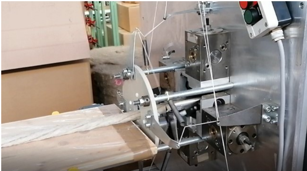
Abb. 11: KEMAFIL-Maschine mit einem Kopfdurchmesser von 30 mm
