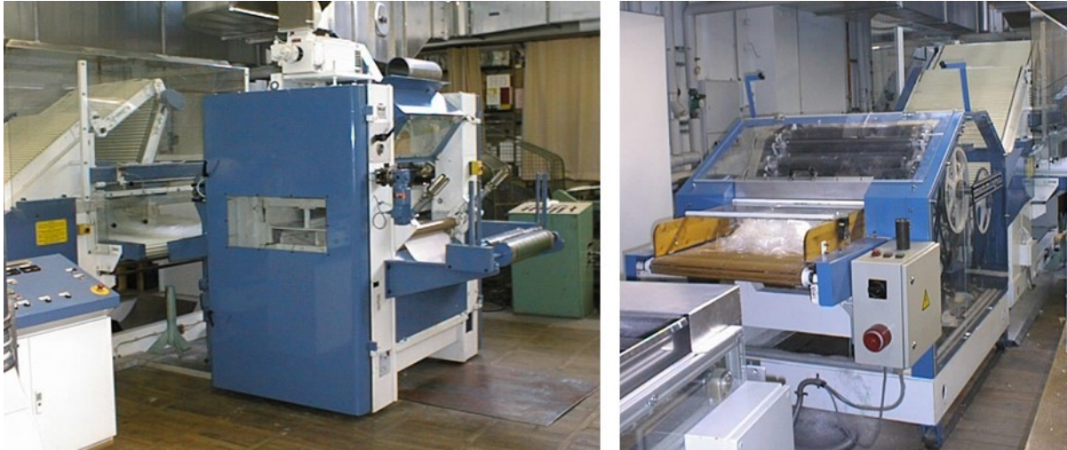
Abb. 13: Vliesstofflaboranlage bestehend aus Krempel und mechanischer Verfestigung in Form einer Dilo Nadelmaschine
