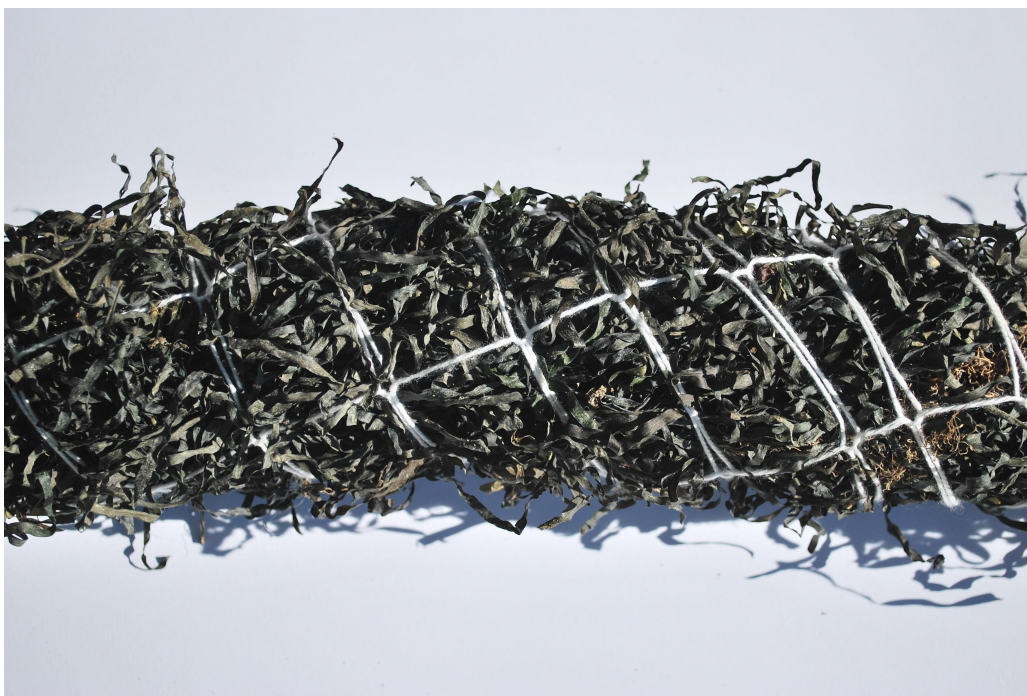
Abb. 3: Aus getrocknetem Seegras gefertigter Strang. Die Struktur von getrocknetem Seegras ist mit der von zerknittertem Lametta vergleichbar. Die Schenkellängen des Maschenmantels sind in Bezug auf den Strangdurchmesser kleiner.
