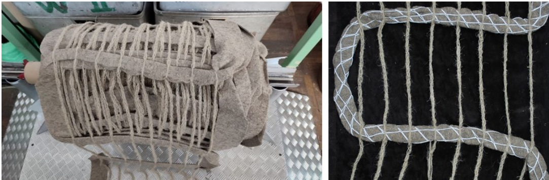
Abb. 10: Vliesstoffgitter aus Hanf-Flachs-Gemisch, links: bestehend aus Vliesstoffstreifen, rechts: bestehend aus strangförmiger Kernmantelstruktur, vergl. Abbildung 9
