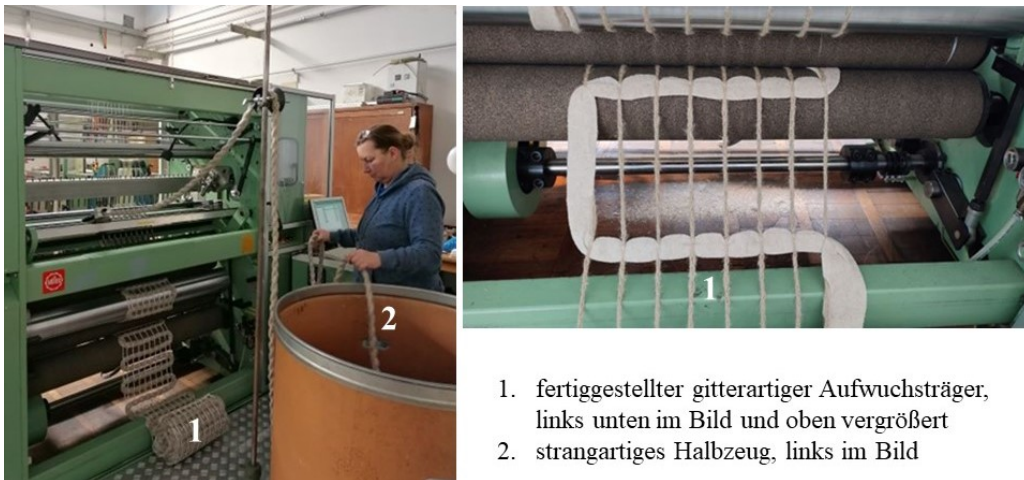
Abb. 12: RR-Kettenwirkmaschine GWM 1200 zur Herstellung von gitter- und netzartigen Strukturen
