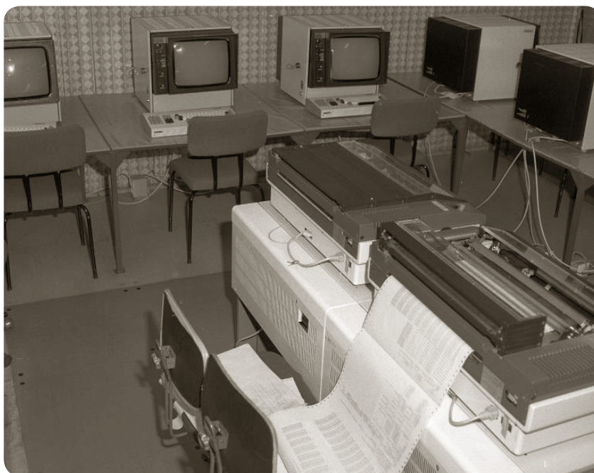
Die ESER-Terminals dienen den Nutzern zur Eingabe von Programmen und Daten. Es waren keine grafischen Terminals, aber man konnte mit Hilfe eines Editors seine Programme und Daten eingeben und auch korrigieren. Die Terminals standen nicht im Maschinensaal und waren so für alle Nutzer erreichbar. Es gab allerdings an der gesamten Universität nur sieben Terminals. Quelle: Universität Rostock, IT- und Medienzentrum.
