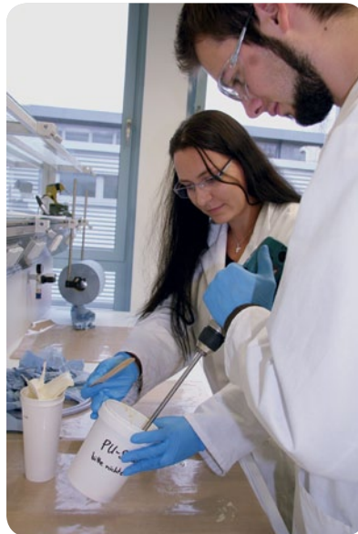
Maschinenbaustudentin Linda Fröck rührt mit ihrem Kollegen Steffen Claußen den Zwei-Komponenten-PU-Schaum an. Quelle: BildIng
