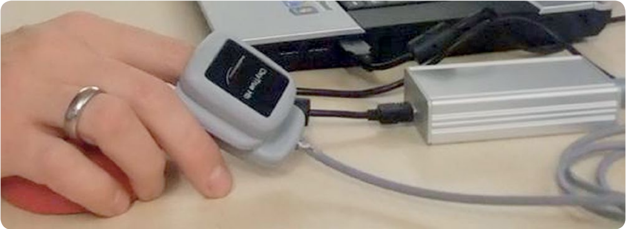
Online-Software zur Bestimmung der Blutparameter und Sensorprototyp (DSP-Board und Sensorkopf zur Hämoglobinbestimmung während einer Messung)
