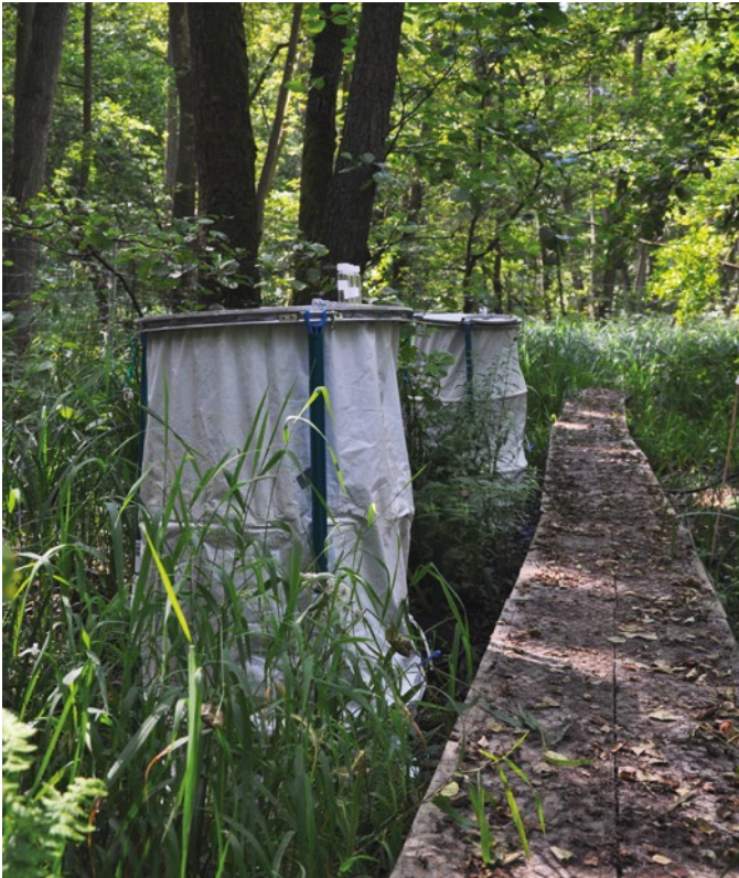
Abb. 2: Installationen zum Messen des Gasaustausches zwischen Moorboden und Atmosphäre in einem wiedervernässten Erlenbruchwald (Quelle: Franziska Schmacka, Uni Rostock).
