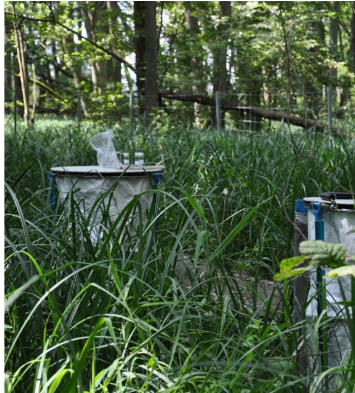
Abb. 2: Installationen zum Messen des Gasaustausches zwischen Moorboden und Atmosphäre in einem wiedervernässten Erlenbruchwald (Quelle: Franziska Schmacka, Uni Rostock).
