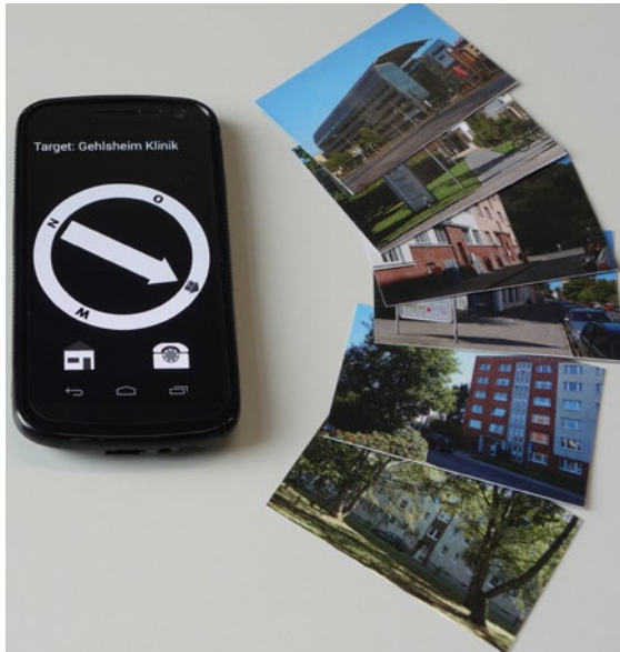
Abb. 2: Navigationsassistent mit kontrastreicher, minimalistischer Benutzeroberfläche. Durch Berühren des Smartphones mit einer der rechts abgebildeten Karten lässt sich der Assistent auf einen Zielort programmieren.
