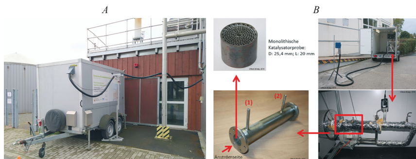
Abb. 2: Örtlich mobile Katalysortestanlage (MoKatTA) zum Einsatz am Realabgas. A: MoKatTA installiert am BHKW-Abgaskanal am DBFZ (© T. Schliermann 2024). B: Bisherige einstufige MoKatTA-Konfiguration zum Projektstart bestehend aus Abgassonde, Rohrofen und Katalysatorhalterung für kleinskalige monolithische Katalysatoren (© René Bindig, 2019).
