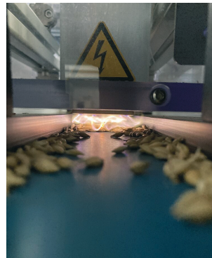
Abb. 3: Förderband – Plasma-anwendung am Korn
