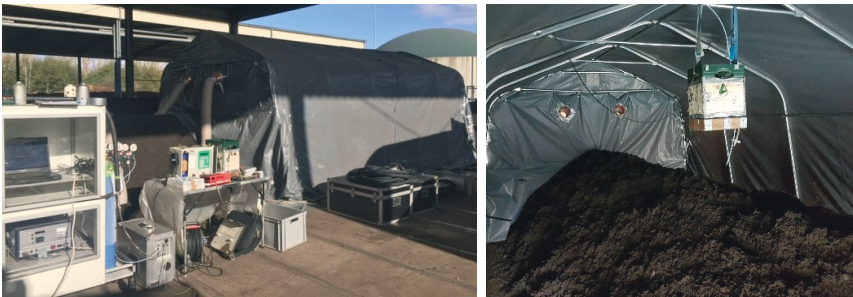
Abb. 1 a) Versuchsaufbau und Nutzung des FID an einer Vergärungs-/Kompostierungsanlagen mit Dreiecksmiete
