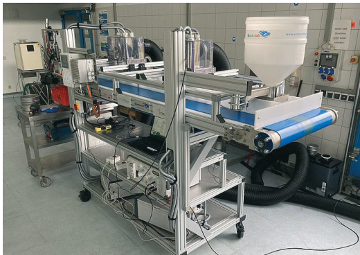
Abb. 2: Förderband – entwickelt zur Plasma-anwendung verschiedener Getreidearten
