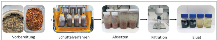
Abb. 2: Schüttelverfahren zur Herstellung des Eluats
