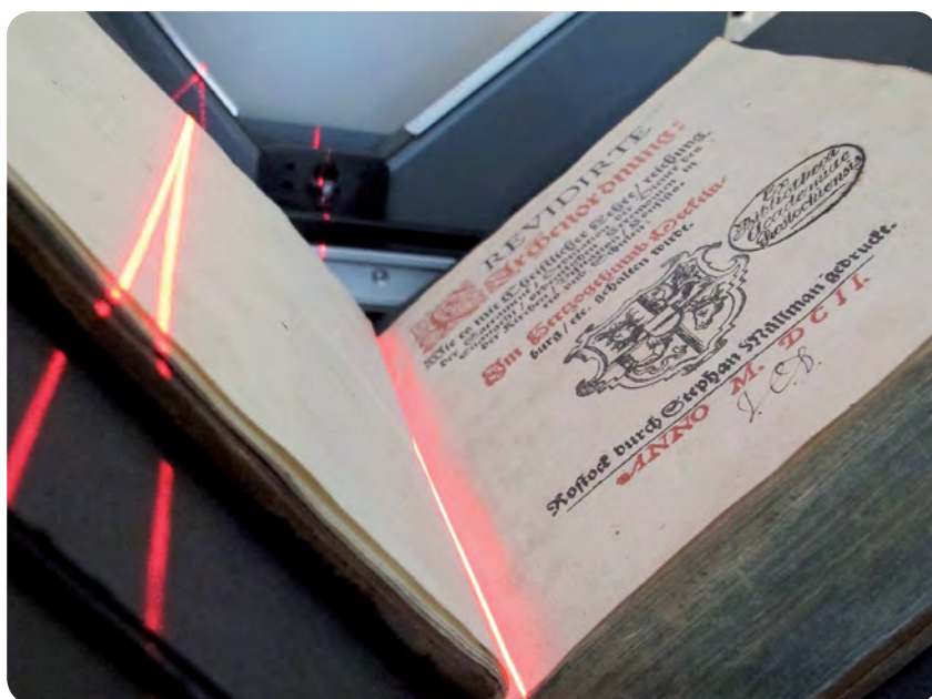
Digitalisierung mit dem 90°-Buchscanner
