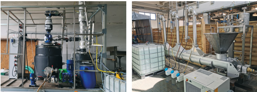
Abb. 1: Versuchsanlage zur fraktionierten Eindampfung (links) und zur Trocknung von Stroh mit Ammoniakrückgewinnung (rechts)
