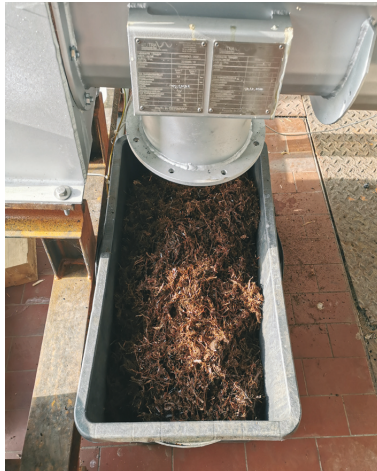
Abb. 3: Austrag des Schneckentrockners mit getrocknetem, gebeiztem Stroh
