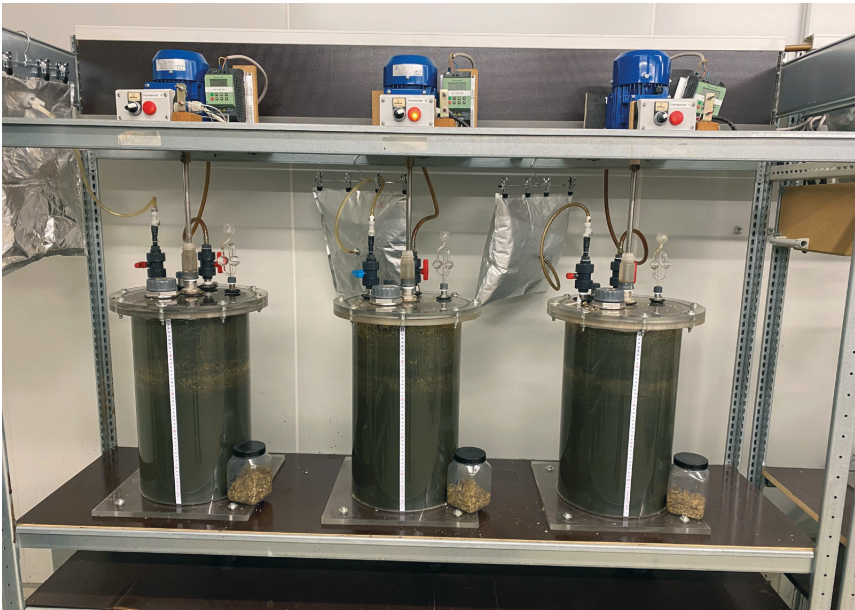
Abb. 1: Kontinuierliche Biogasfermenter der ISF GmbH
