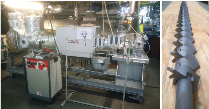
Abb. 2: Aufbau der Technikumsversuchsanlage und SiC-Reaktorschneckenwelle
