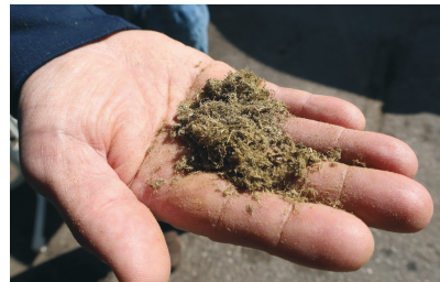
Abb. 4: (a) heterogene Nasswiesenbiomasse, (b) qualitativ hochwertige, homogene Paludifaser nach dem florafuel-Aufbereitungsverfahren
