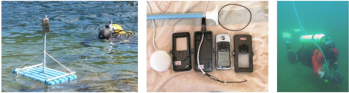
Abb. 3: Links: GPS-Einsatz (Variante 2a). Mitte und rechts: GPS-Handheld im UW-Gehäuse (Variante 2b).
