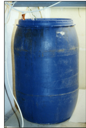
Abb. 3 100-L Gefäße dienten als Labor-Mesokosmen. Ein Ansatz des Experimentes KOLA 89/1 wurde von 1990 bis 2007 bei konstanten Temperaturen kultiviert und 2x wöchentlich beprobt. Die aus dieser Langzeitserie hervorgegangenen Daten dienen später einem internationalen Team als experimenteller Beweis für die Möglichkeit chaotischer Dynamik in einem kompletten Ökosystem (Nature 451, 822 – 825, 1998).
