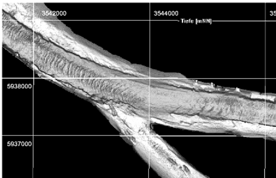
Abb. 3 Die Durchbaggerung der erosionsfesten Kleilage ist noch heute auf den Tiefenplänen erkennbar
