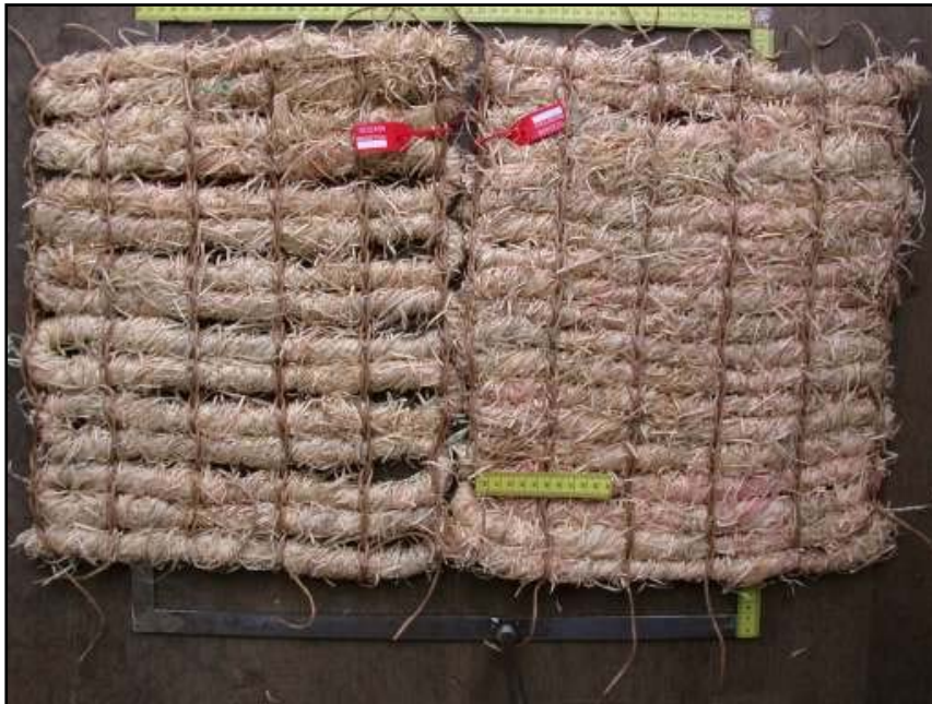
Abb. 1 Probemuster der textilen Vegetationsträger aus Holzwolle (maschenbildendes Grundfadensystem Papier- und Hanffaden). Links die gitterartige, rechts die lichtdichte Variante.
