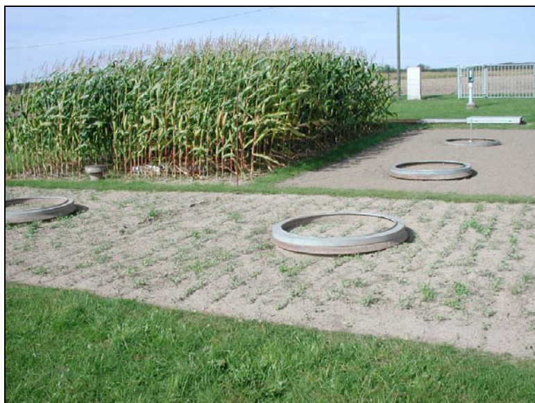
Abb. 3 Lysimeteranlage Groß Lüsewitz
