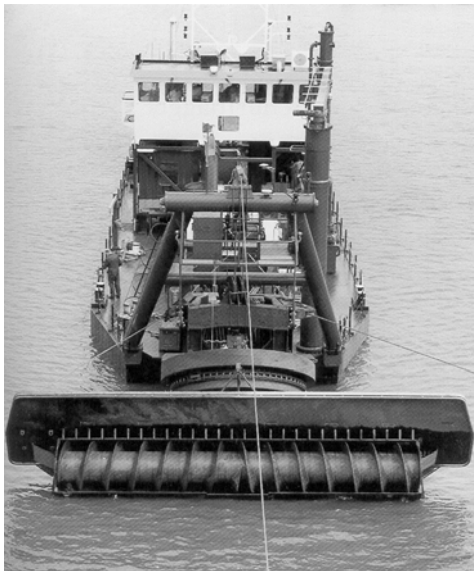
Abb. 4 Schneckenbagger (A) und Scheibenbagger (B) – Quelle: IADC/CEDA 1998
