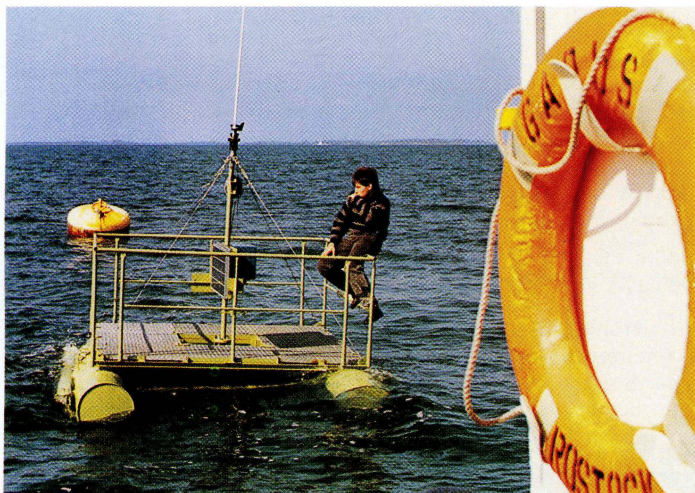
Abb. 1 Ponton als Träger der Gewässersonde, zwischen 2 Festmachertonnen liegend. Man erkennt in der Mitte den Mast mit Solarzelle, Sensorsteuereinheit (blaue Kiste), Sensoren und Funkantenne
