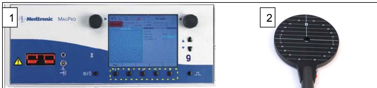
Abb. 16. Magnetstimulator und die verwendete Spule. 1 = MagPro R30, 2 = MC-125 Circular Spule
