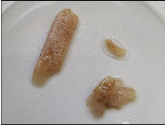
Abb. 75: In die ZK gespülte Schlauchablagerungen
