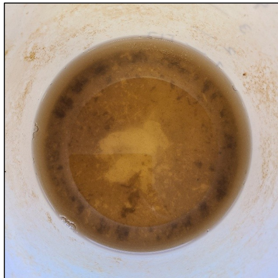
Abb. 81: PW-Feed nach 5 Tagen (Lagerung bei 22 °C, automatische Teilent- nahme via Pumpe alle 8 h)
