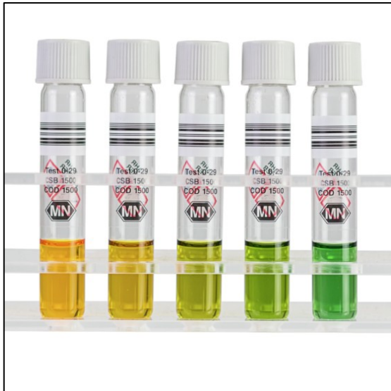
Abb. 45: Konzentrationsreihe des CSB-NANO-COLOR-Rundküvettestes mit steigender CSB-Konzentration (entnommen aus [37])
