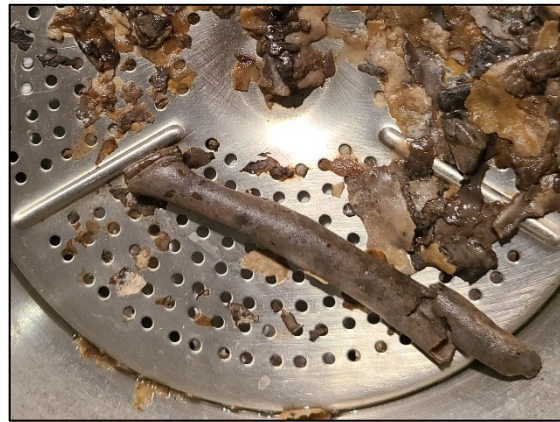
Abb. 58: Große, aus dem Schlauch ausgespülte organische Ablagerung
