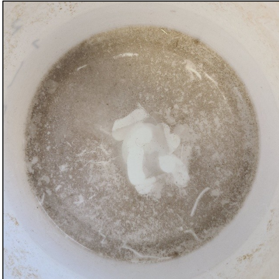
Abb. 82: Nicht ausgeschwemmter Bodensatz im Feed-Tank
