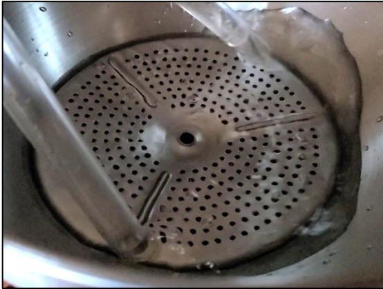
Abb. 29: Wassereinstauung über den Sieböffnungen
