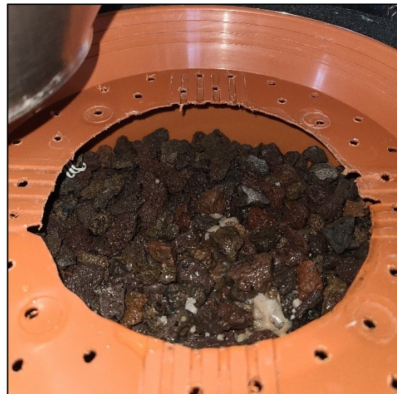
Abb. 74: Durch das Sieb gespülte Schlauchablagerungen
