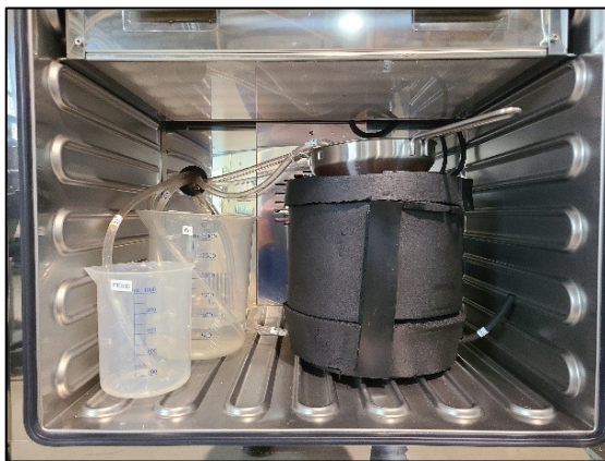
Abb. 27: Feed, Zwischenklärung und Tropfkörper (v. l. n. r.)
